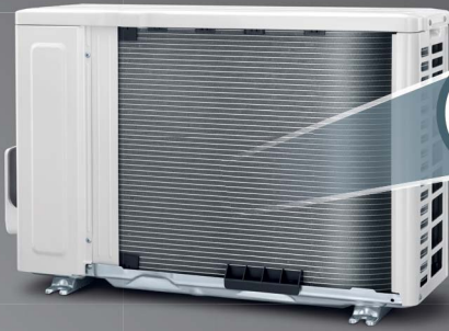
คอยล์อลูมิเนียมอัลลอยเกรดพิเศษ ผสม Zinc และเคลือบสารพิเศษ ป้องกันการกัดกร่อน
